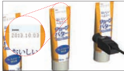
黃油醬的保質期打印字符檢測
