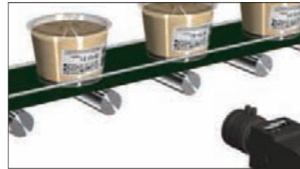
容器的保質期打印字符檢測
