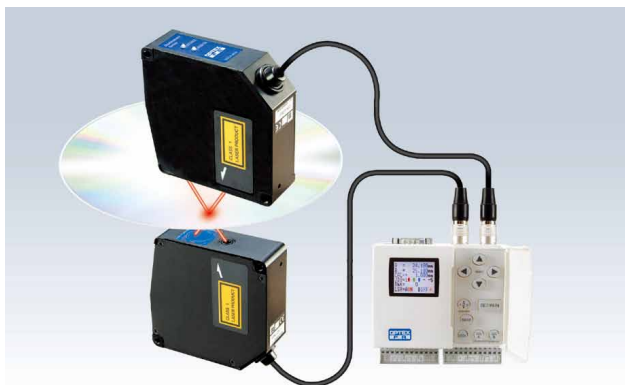
演算し、厚みを測定(正反射型)
